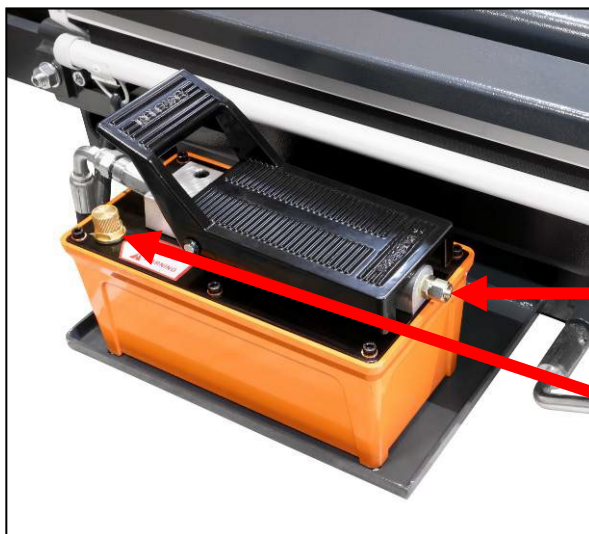
Figure : pompe pneumatique
