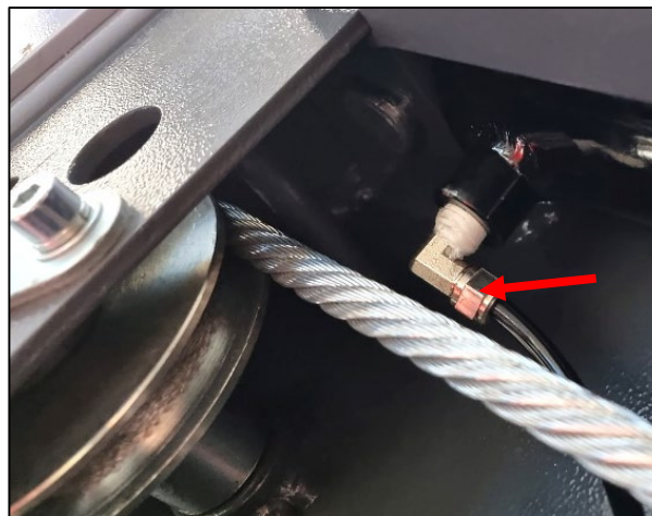
Figure : Conduite d'aération
