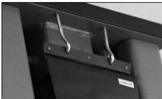
Figure : montage du cache de protection de colonne
