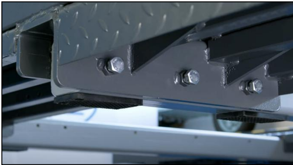
Figure : Assemblage des voies par vissage
